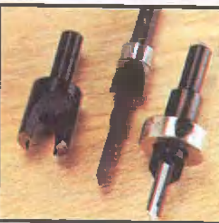
Слева направо: сверло для вырезания пробок; комбинированное сверло для шурупов с полукруглой головкой; комбинированное сверло (с переставным ограничителем глубины сверления).
